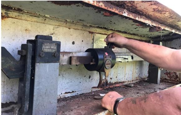
Blick auf den Mechanismus im Innern des Gehäuses. Dieser ist grundsätzlich noch immer funktionstüchtig. Der Rost wurde bei der Renovation entfernt und die Farbe erneuert.
